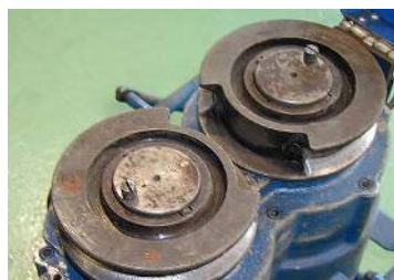
写真2: ダイス取り付け部
