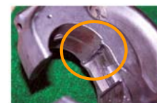
写真4: ヘッド部爪破損
