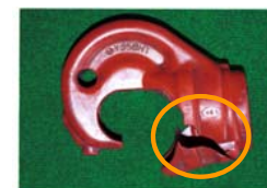
写真3: ゴムカバ破損
