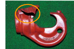
写真3：ゴムカバ破損
