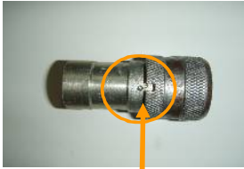
写真6：カップラーロック不良品 (ロックピンが折れている。)
