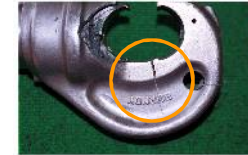
写真2：ヘッド部亀裂
