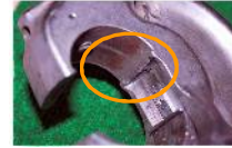
写真1：ヘッド部爪破損
