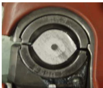
写真1： 定形ダイス(圧縮時に上下ダイスがぶつかる。)
