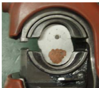
写真2： 非定形ダイス(圧縮時にダイスがぶつからない。)
