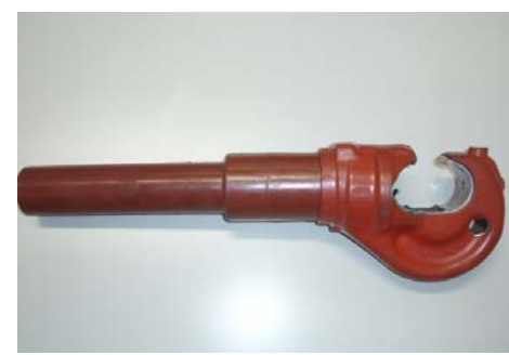
写真4 : カバーを装着した12トンヘッド
