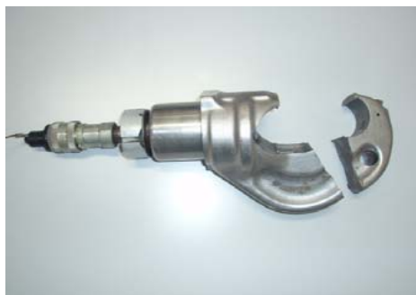
写真1 : 12トンヘッド 破損例
