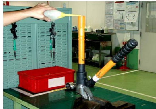
写真2：手動12トン工具に作動油を補充している様子
