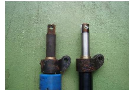
写真3： シリンダ一部錆発生品と新品との比較
