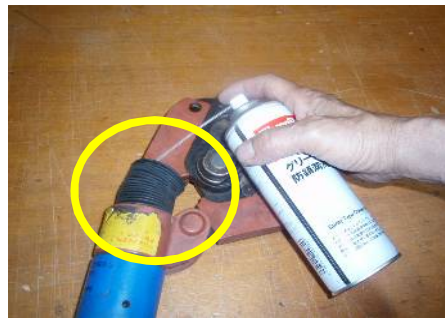
写真2： シリンダ一部防錆
