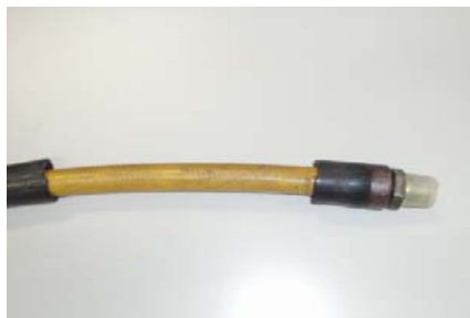
写真1: ホースのプロテクター破損
