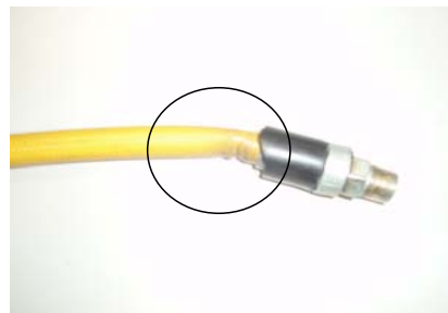
写真2: ホースの折れ曲がり(キンク)
