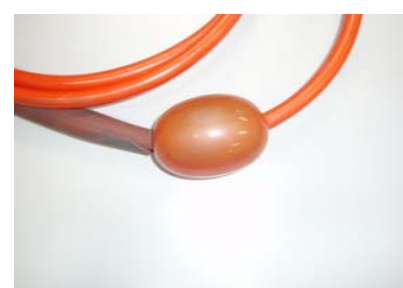
写真4: ホース表面の膨らみ
