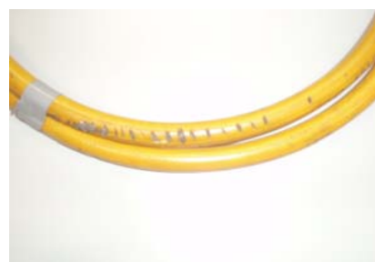
写真3: ホース表面の傷
