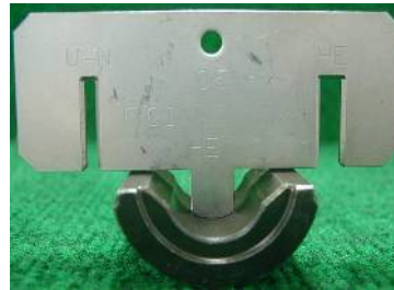
分岐用ダイス摩耗チェックゲージ
