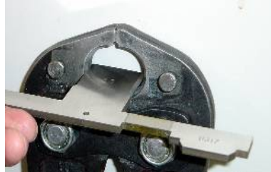
手鋏工具用ダイス摩耗チェックゲージ
