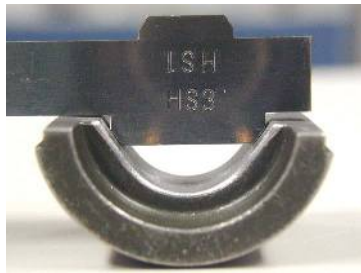
直線用ダイス摩耗チェックゲージ
