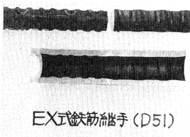
写真 9 スリーブと鉄筋のかみ合い
